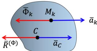
Силы инерции  $\bar{\Phi}_k$  образуют систему параллельных сил, которая приводится к равнодействующей, линия действия которой проходит через центр масс тела.
