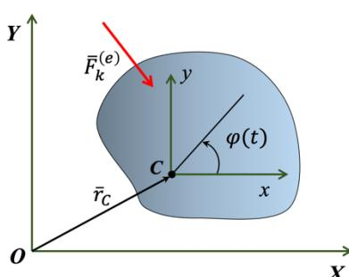
Рассмотрим плоское движение твердого тела как сложное по отношению к неподвижной системе координат  $OXY$ .
