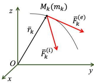
Рассмотрим движение механической системы, состоящей из точек  $M_k$ , массой  $m_k$ ,  $k = \overline{1, N}$  под действием внешних и внутренних сил.
