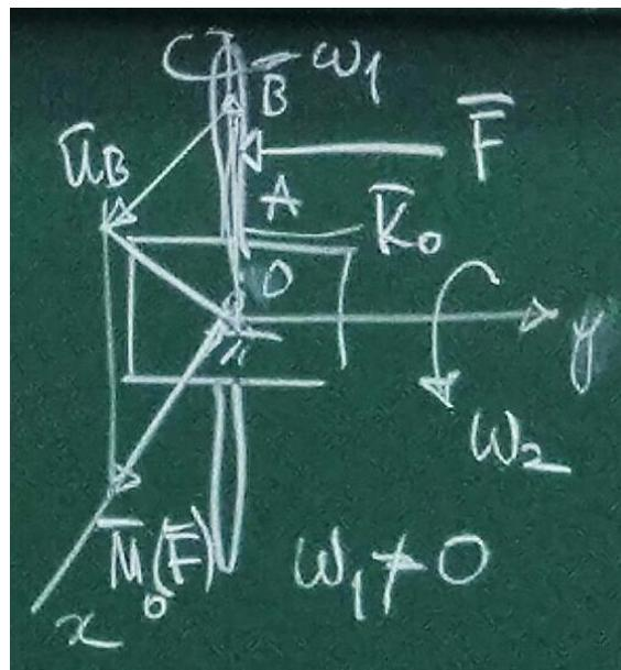
Правило прецессии: если к гироскопу приложена система внешних сил, главный момент которых относительно неподвижной точки гироскопа, отличен от нуля, то та часть оси гироскопа, по которой направлен его кинетический момент, будет прецессировать в направлении вектора главного момента внешних сил, приложенных к нему.
