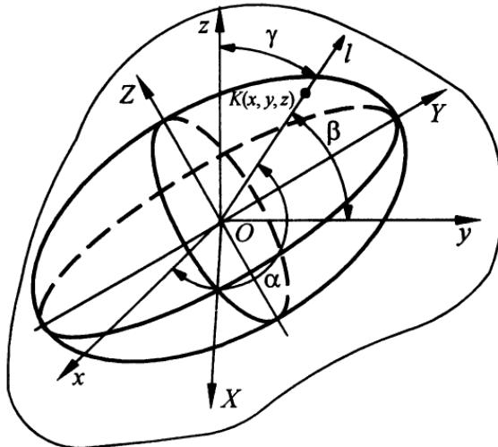
Получим уравнение эллипса инерции в системе координат  $Oxyz$  (рис. 14.18). Подставив выражения  $\cos \alpha = x/OK = \sqrt{J_l} x$ ,  $\cos \beta = y/OK = \sqrt{J_l} y$ ,  $\cos \gamma = z/OK = \sqrt{J_l} z$  в формулу (14.13), получим
