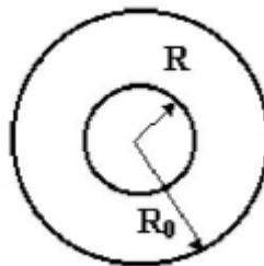
Построить графически распределение модулей векторов электрического поля  $E$ , поляризованности  $P$  и электрического смещения  $D$  между обкладками конденсатора. Определить поверхностную плотность связанных зарядов на внутренней  $\sigma_1'$  и внешней  $\sigma_2'$  поверхностях диэлектрика, распределение объёмной плотности связанных зарядов  $\rho'(r)$ , максимальную напряженность электрического поля  $E$  и ёмкость конденсатора.
