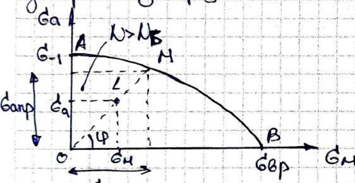
Точки лежащие на краю АМВ, соответствующих циклы при которых образец разрушается, выдержав большое число циклов.
