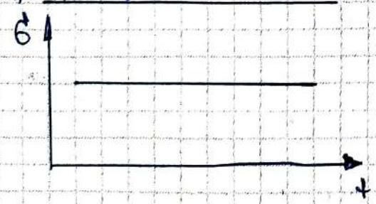
Цикл с одинаковой коэффициентом асимметрии изгибающей нагрузки.
