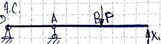
Заданное реакции  $X_1$  находят исходя из того, что перемещение точки С под действием заданной нагрузки  $\Delta P$  равно нулю и противоположно по знаку перемещению этой точки под действием реакции  $X_1$ .
