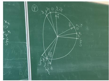
Указанная ск получила широкое распространение при исследовании динамики в гироскопии. Ось x - это продольная ось ЛА, ось z - поперечная ось в правое крыло, ось у - вертикальная ось ЛА. Пси в этом случае - угол курса (рыскания) ЛА. Угол тета - угол тонгажа ЛА (дифферента если корабль), угол фи - это угол крена. Эти определения неправильные, они для наглядности.
