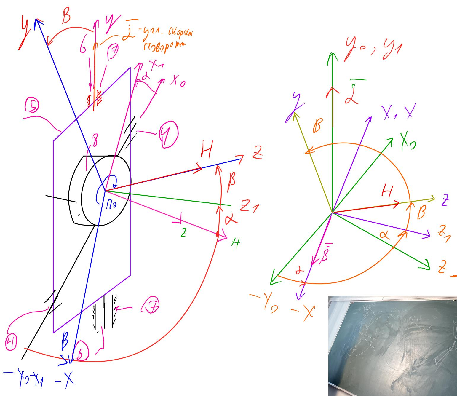
Задание углового положения главной оси трёхстепенного гироскопа относительно ск связанной с основанием
