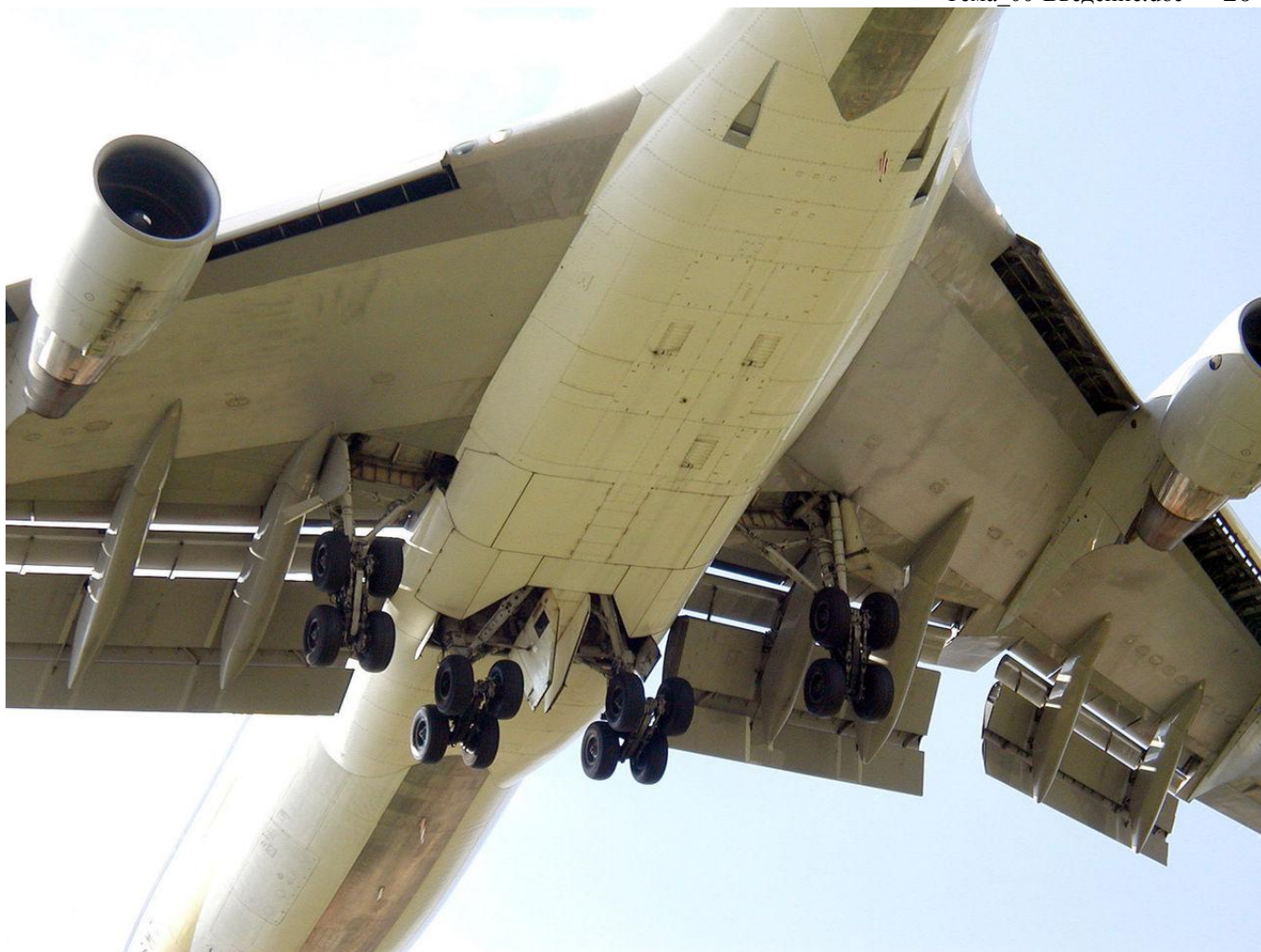
Boeing-747 с выпущенными закрылками и предкрылками
