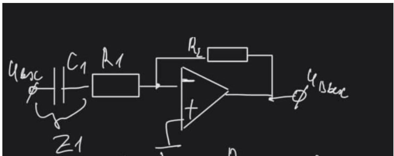
12. Нарисовать схему неинвертирующего усилителя на ОУ с ограничением полосы частот «снизу»
