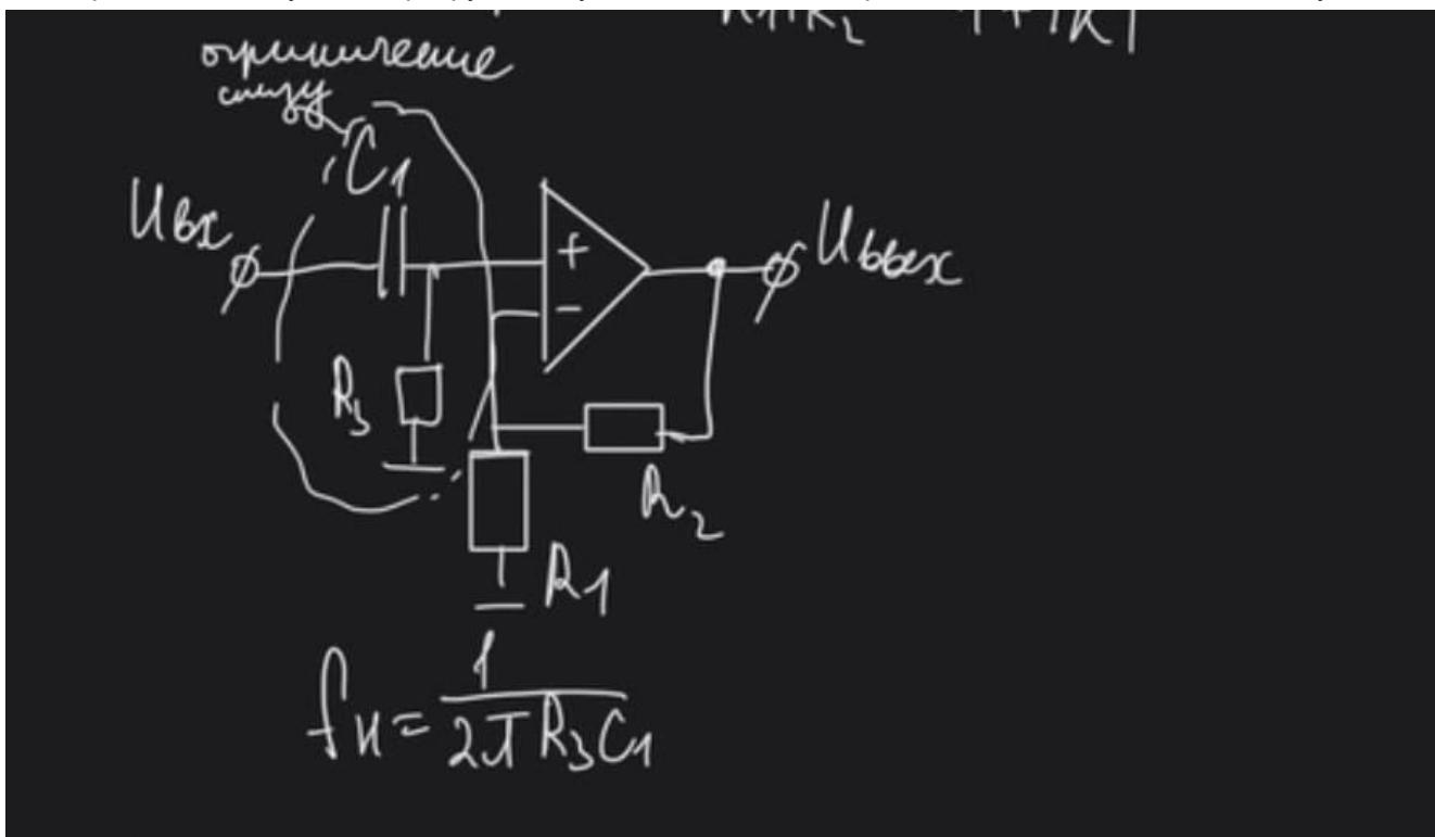
13. Нарисовать схему инвертирующего усилителя на ОУ с дополнительным ограничением полосы частот «сверху»
