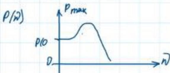
В таком случае переходной процесс системы можно представить двумя трапециями
