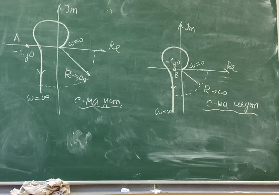
Если система неустойчива в разомкнутом состоянии и имеет  $M$  корней в правой полуплоскости, то для устойчивости соответствующей замкнутой системы необходимо и достаточно чтобы АФЧХ разомкнутой системы для частоты от нуля до бесконечности охватывало точку  $-1$   $J0$   $m/2$  раз
