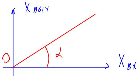
При различной физической природе выходной и входной переменных их отношение называется **коэффициентом передачи** (потенциометр).
