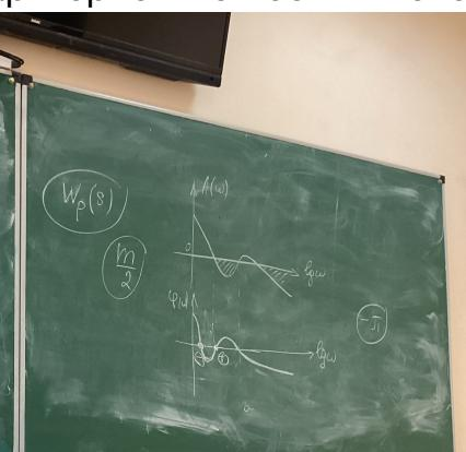
Практическое значение получило случай при анализе замкнутой системы, когда разомкнутая система устойчива. Замкнутая система будет устойчива в том случае если лфчх пересекает ось -пи сверху вниз после частоты среза
