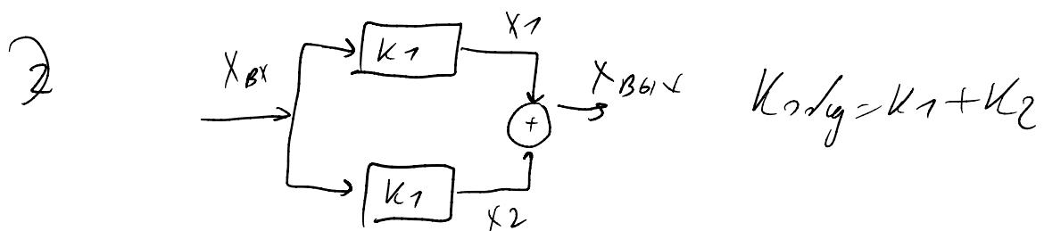
Эквивалентный коэффициент или передачи параллельного соединения
