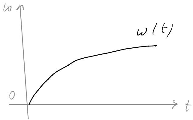
Вывод: если бы система двигалась с первоначальной скоростью, то она достигла бы установившейся скорости через время T, считается что переходной процесс устанавливается через 3..4T и характеризует инерционность системы.
