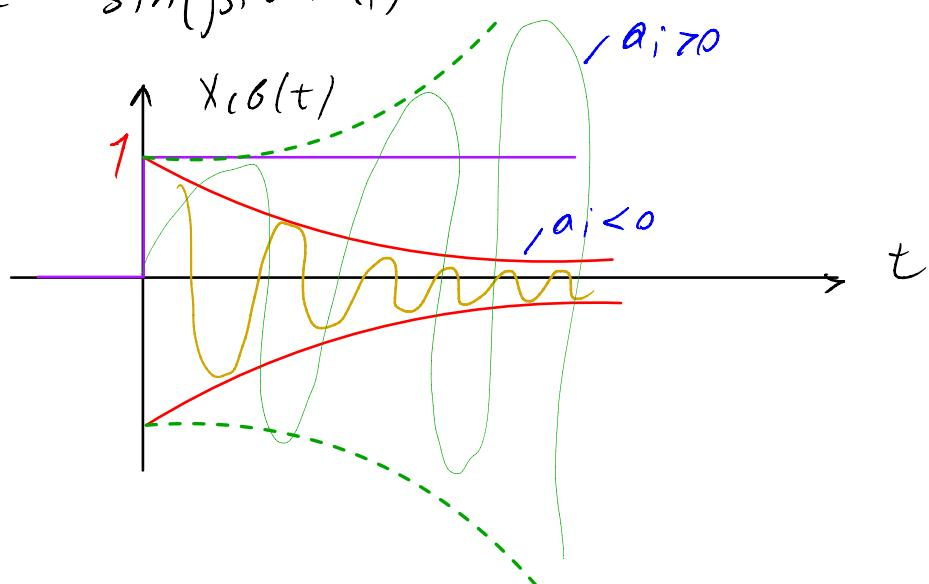
Система будет устойчива при отрицательных вещественных корнях и при отрицательных значениях вещественных частей комплексных корней. Если среди корней характеристического уравнения будет хотя бы одна пара чисто мнимых ( $a_i=0, b_i \neq 0$ ), то появляется составляющая свободного движения в виде незатухающего колебательного процесса. Не автоколебания!! В этом случае система будет находиться на границе асимптотической устойчивости и не устойчивости.
