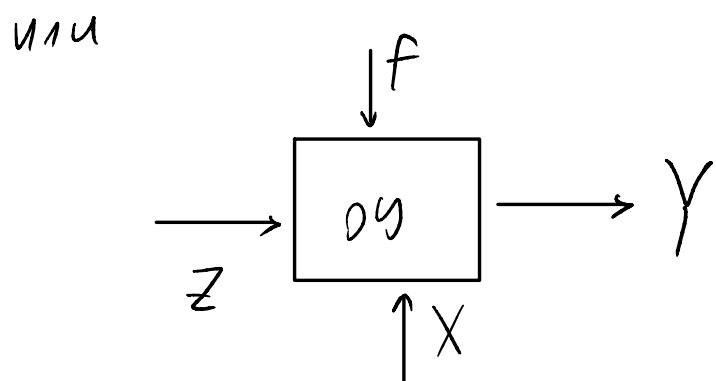
$Z (z_1, \dots, z_r)$  - Совокупность контролируемых внешних воздействий
