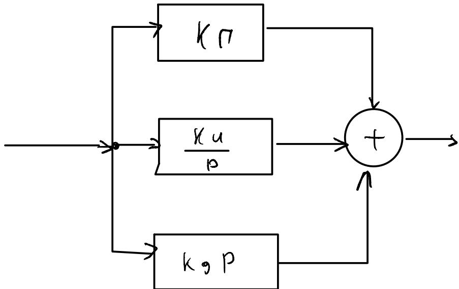
Усилитель с коэффициентом Кр пропорциональности, интегратор с коэффициентом Ки, дифференциатор с коэффициентом Кд
