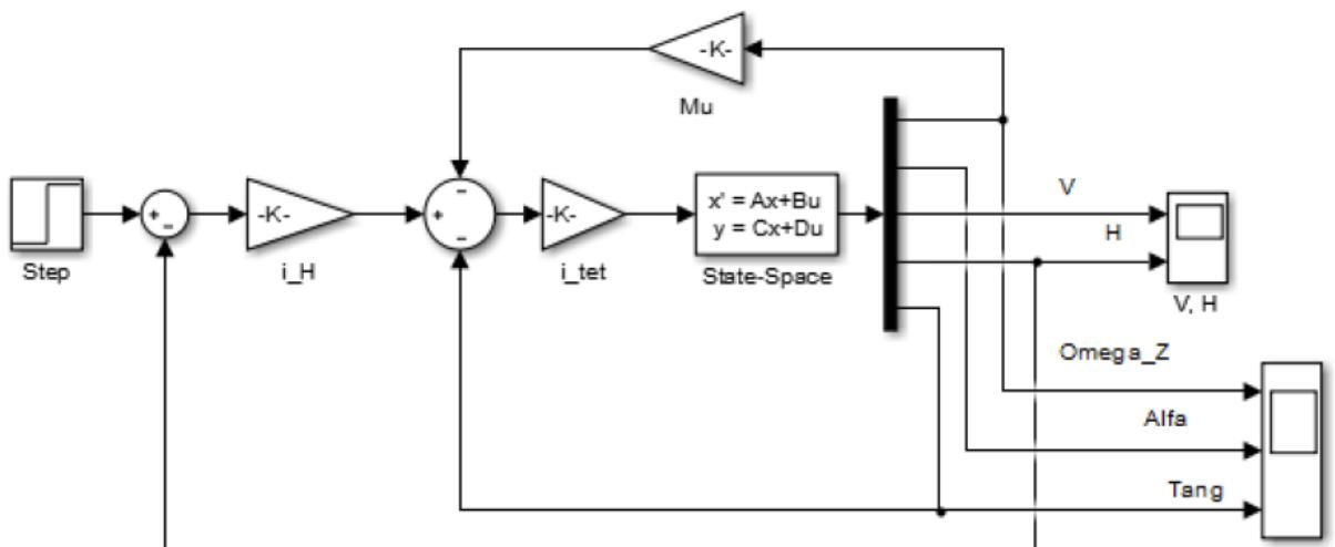
От линий связи, по которым проходят значения выходных параметров, можно взять сигналы для контура управления. На схеме сформирован контур демпфирования по параметру  $\omega_z$ , а также контур автопилота стабилизации тангажа и высоты полета.
