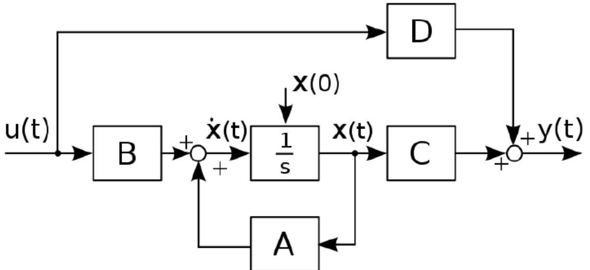
Вычислительная схема модели динамической системы в пространстве состояний, блок интегрирования на схеме означает покомпонентное интегрирование вектора  $\dot{\mathbf{X}}(t)$ .
