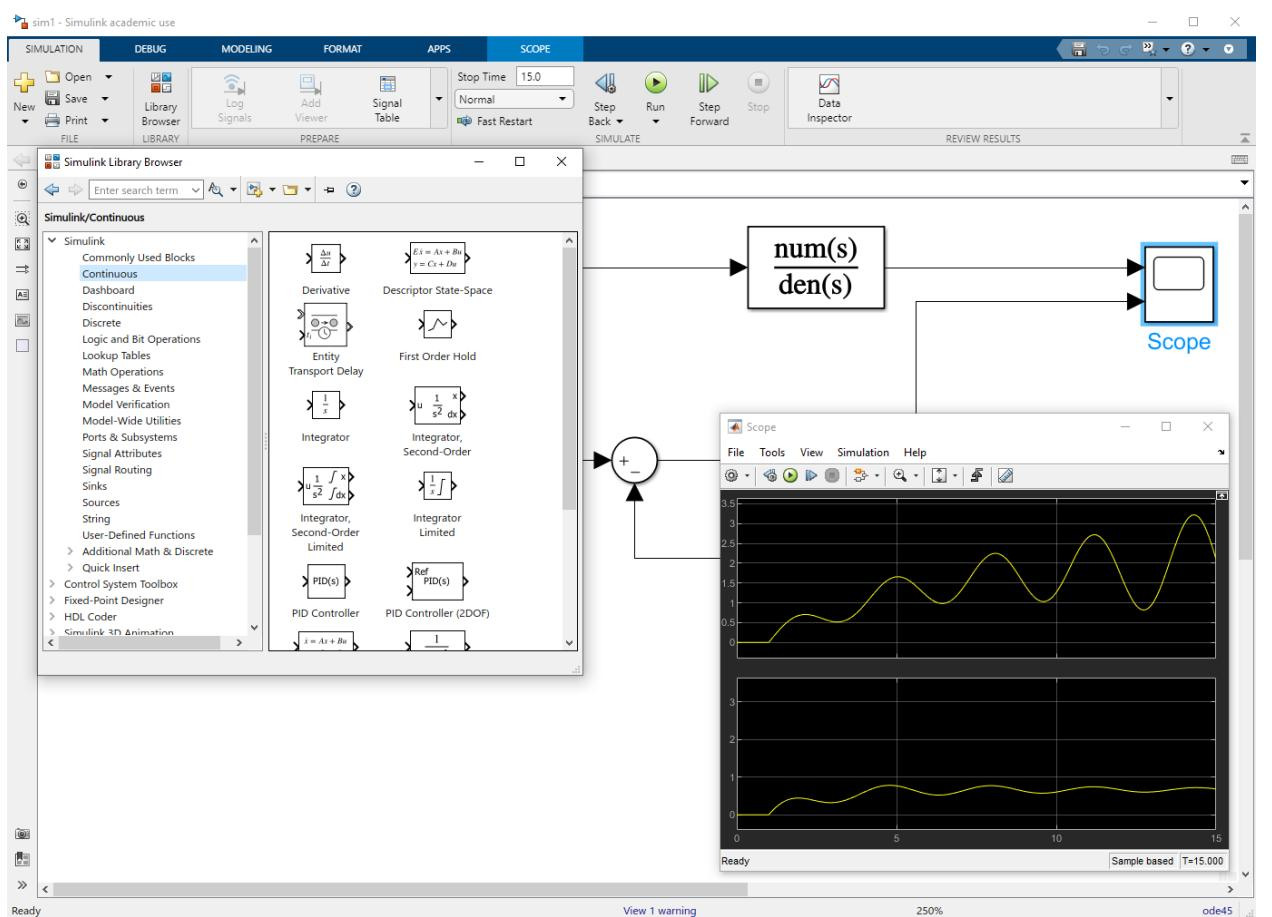
Модель состоит из блоков и связей, или линий передачи сигналов. Блоки сгруппированы по назначению, группы отображаются в виде иерархической структуры в окне библиотеки.
