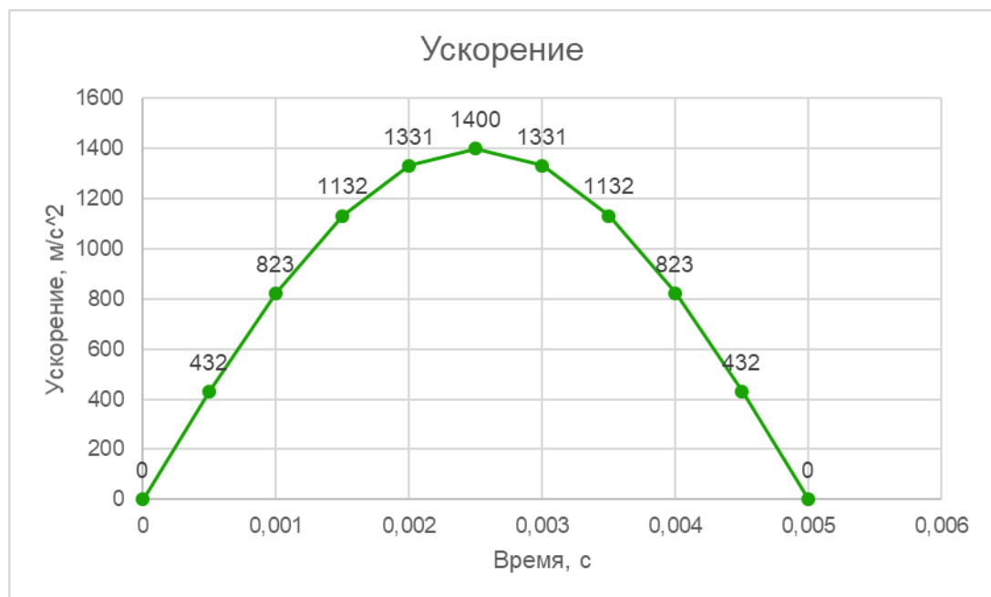
Рис. 32. График ускорения при ударном воздействии амплитудой 140g (Вариант 2)
